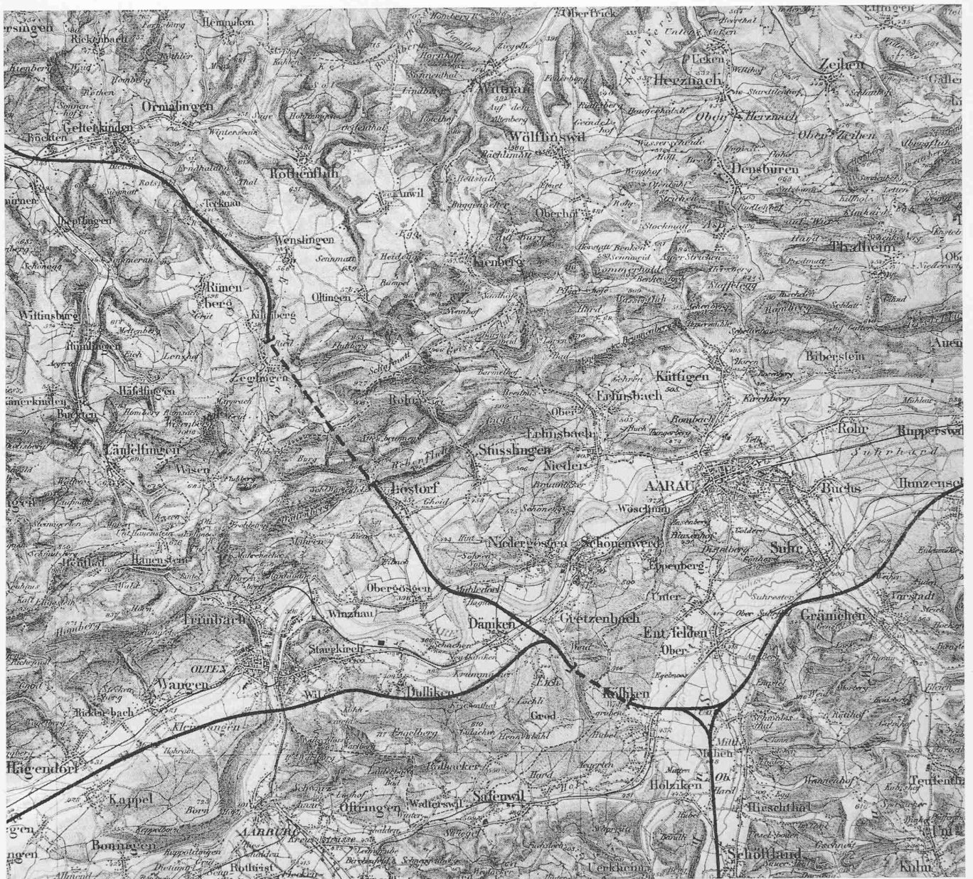
Bild 3. Einzelheiten des Vorschlags Bild 2: Das Zentrum des schweizerischen Strassenkreuzes bei Kölliken - Däniken und der 4½ km lange Jura-tunnel Liestorf - Zeglingen des Nordarms. Führung des Westarms südlich von Olten. Masstab 1:125 000.
