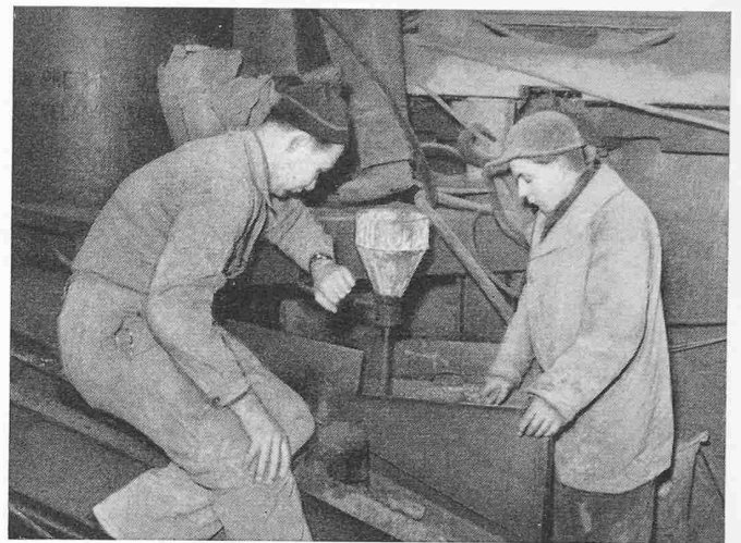
Bild 10. Ausflussversuch aus dem Flow-Cone zur Bestimmung der Konsistenz (Wasserkontrolle) des Prepakt-Mörtels
