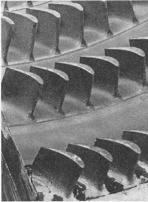
Bild 8. Schaufelträger der Hochdruckturbine, Stufen 1, 2 und 3, nach 700 h Betrieb mit Brennöl II + Zusatz und p_{max} = 25 atü, t_{max} = 675 °C
