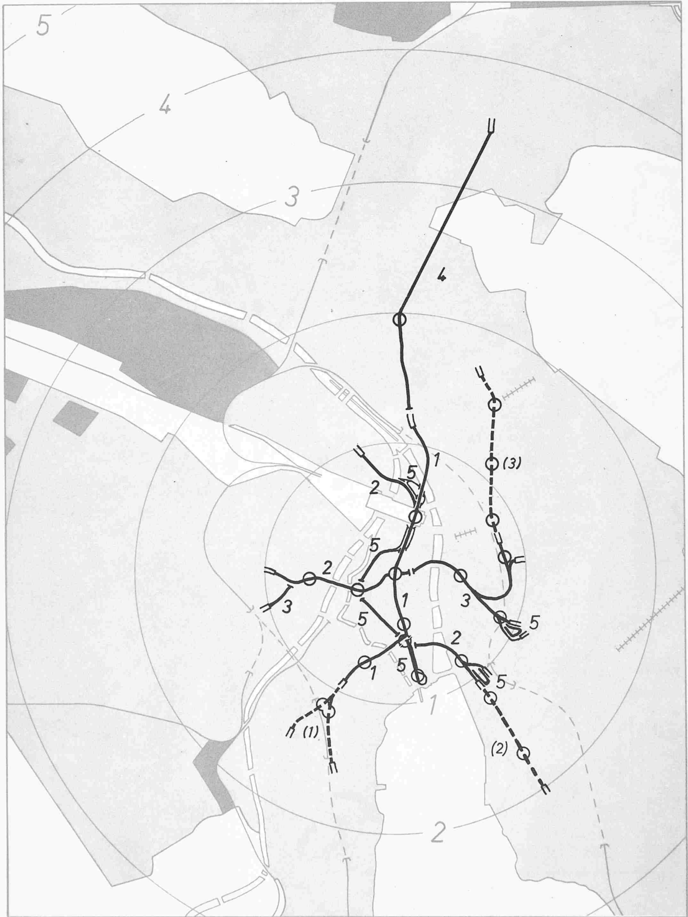
Bild 7. Ausführungsvorschlag für ein unterirdisches Schnell-Strassenbahn-System; Bauperioden
