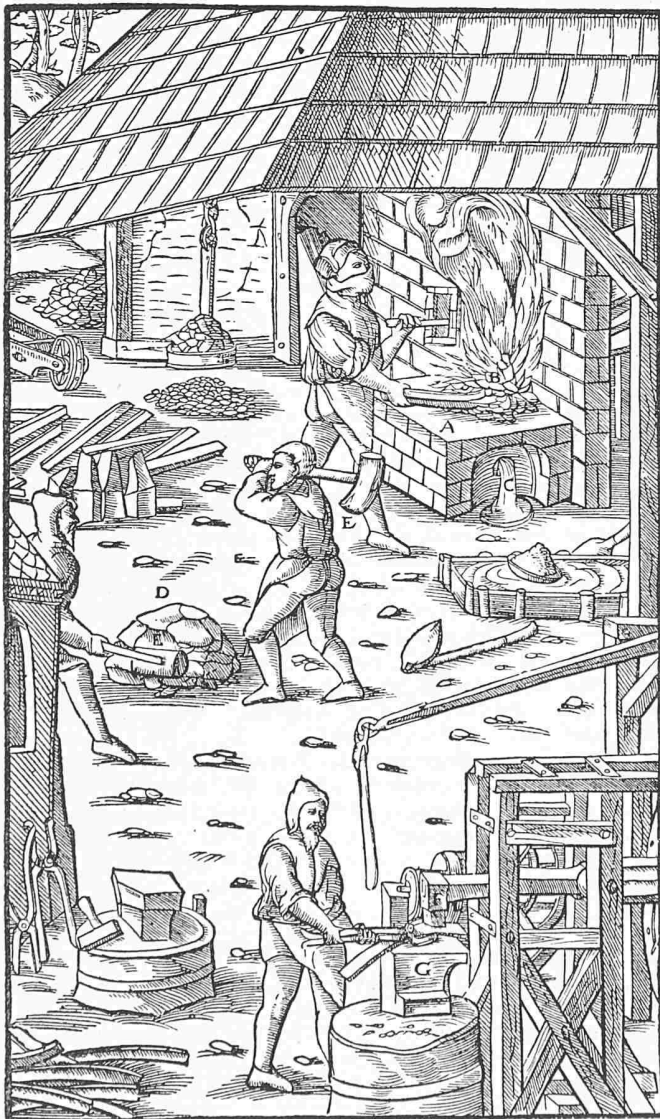
Bild 2. Rennfeuer. A Herd, B Beschickungshaufen, C Schlackenabfluss, D Eisenklumpen (Massel), E Holzhammer, F grosser eiserner Hammer, G Amboss
