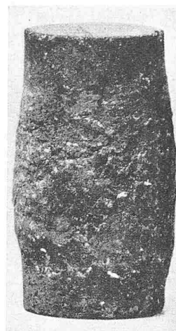
Bild 5. Zementmörtel 1:3, Druckversuch p_a = 510 Atü. Zylinder \phi 20 mm, Länge 50 mm
