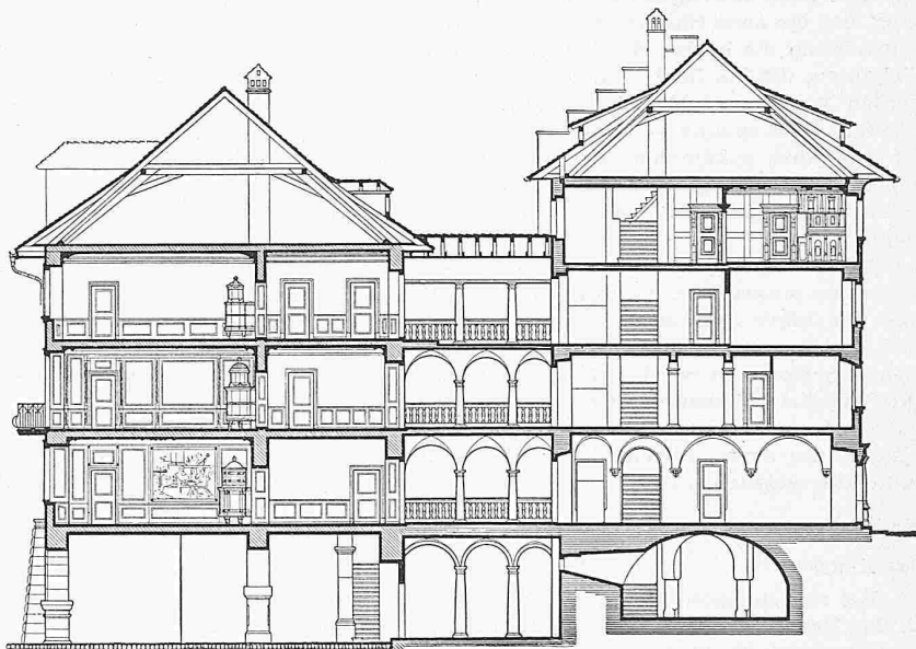
Bild 9. Am Rhyn-Haus, Schnitt Süd-Nord
