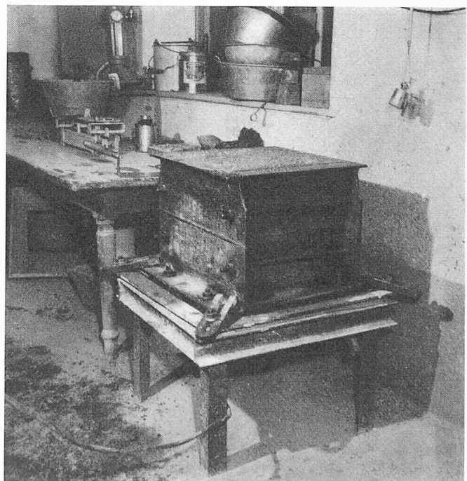
Bild 7. Vibration eines Probekörpers 40/40/40 cm auf dem Rütteltisch. An der Unterseite der auf Gummistreifen gelagerten Tischplatte ist ein Schalungs-Vibrator befestigt
