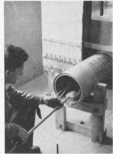
Bild 12. Sandentnahme während des Vortriebes des Versuchstunnels im Laboratorium
