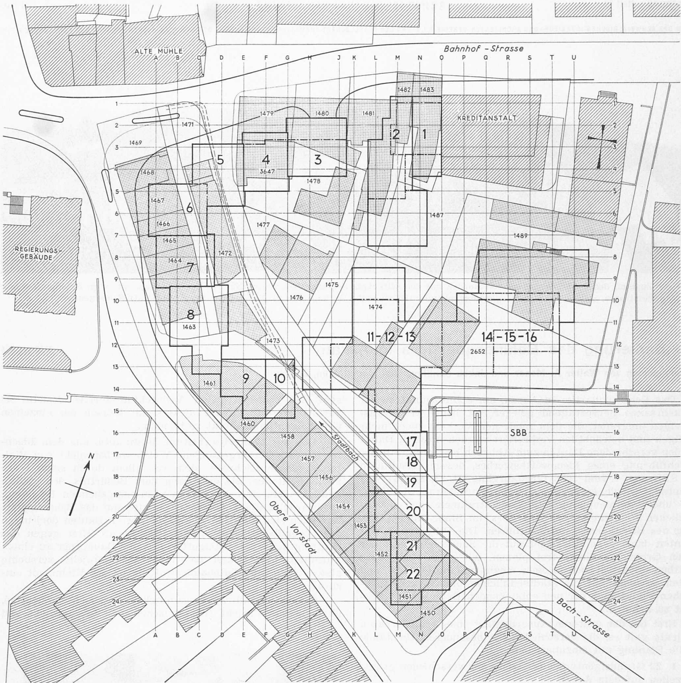
Das Behmenareal in Aarau, Uebersichtsplan 1:1000 mit Eintragung der bestehenden sanierungsbedürftigen Bebauung (punktiert), der angrenzenden, vom Projekt nicht berührten Bebauung (schraffiert) und den neu projektierten Gebäuden (dick ausgezogen). Strichpunktierte Linien deuten die Rücksprünge der Obergeschosse der projektierten Gebäude an
