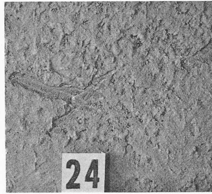
Nr. 24: Schalung aus geölten Eisenplatten. Sehr gute Haftung des ZS
