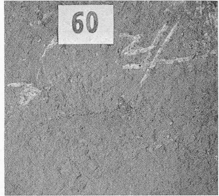
Nr. 60: Schalung unbehandelte Pavatexplatte. Sehr gute Haftung des ZS
