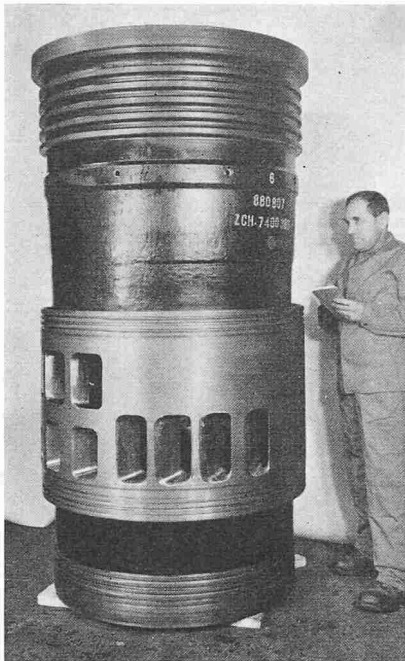
Bild 13. Zylindereinsatz mit Spül- und Auspuffschlitzen
