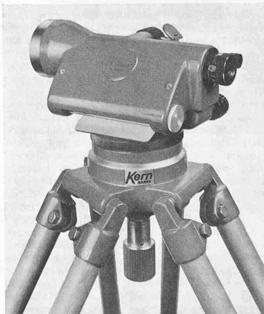
Bild 1 (rechts). Kern-Ingenieur-Nivellier GK 23 auf Gelenkkopfstativ
