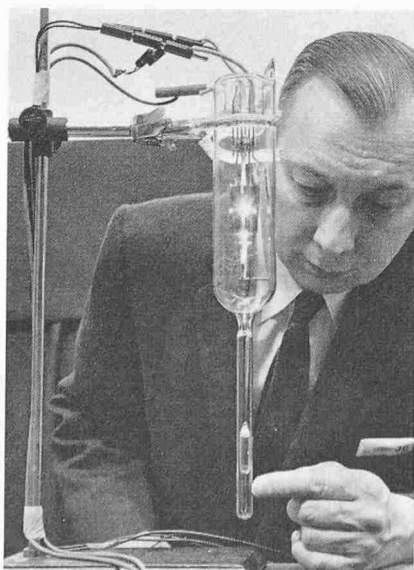
Bild 19. Cs-Versuchs-Diode von Westinghouse. Bei diesem Versuch wird die Kathode (auf Augenhöhe im Glasgehäuse) elektrisch geheizt. Der Versuchs-Ingenieur zeigt auf das Cs-Reservoir
