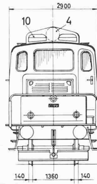
Bild 11. Typenskizze der die-selektischen Rangierlokomotive Em 3/3 (Seriety), Inbetriebsetzung ab 1962
