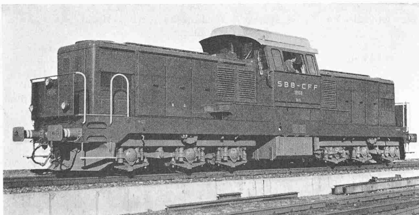
Bild 6. Schwere dieselelektrische Lokomotive Bm 6/6, Baujahr 1960/61
