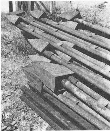
Bild 3. MV-Zuganker mit gesondert geführter Verpressleitung
