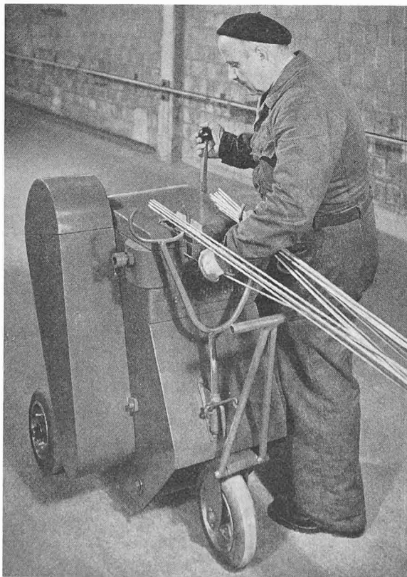
Bild 7. Aufstauchen der Drähte mit Drahtstauchmaschine Vogt (mechanisches Gerät für Drähte bis 8 mm \phi )
