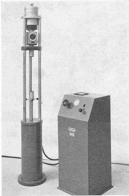
Bild 21. Drahtprüfmaschine mit eingebautem Spezialdynamometer Schmidt und Stossdämpfer für 10 t Risslast
