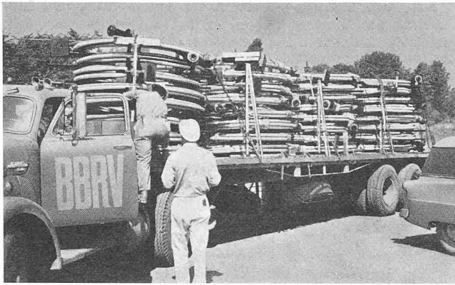
Bild 17. Transport von kreisförmig aufgerollten BBRV-Spanngliedern in den USA (Photo American BBR Inc., Chicago)
