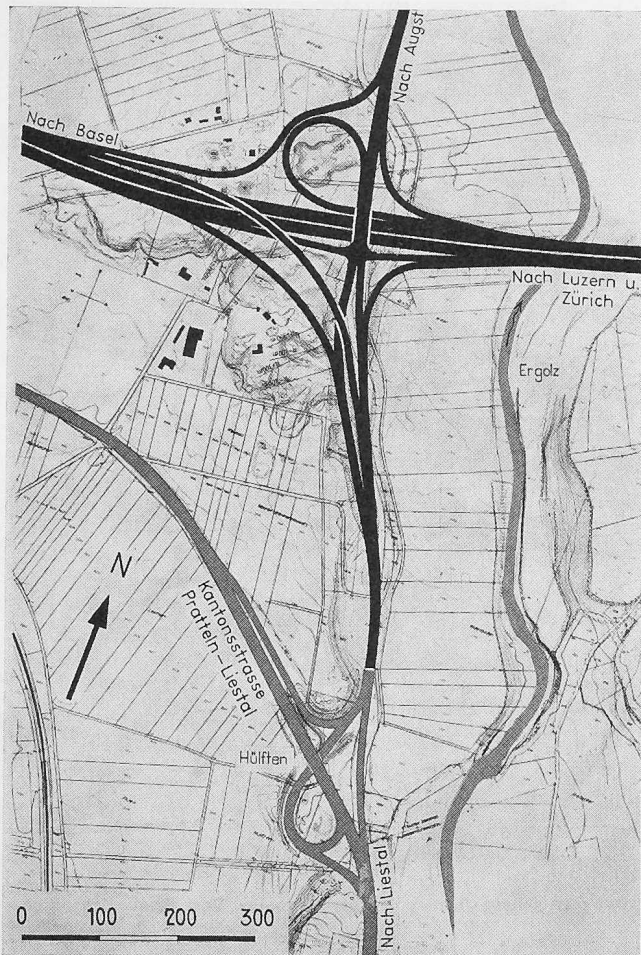
Bild 18. Anschluss Liestal, Lageplan 1:10 000 mit kreuzungsfreier Verbindung ins Ergolztal (Liestal, Oberer Hauenstein)
