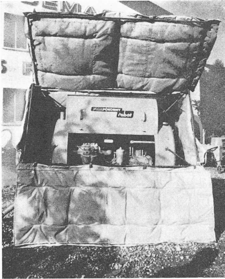
Bild 4. Kompressor in geöffnetem Schallschluckzelt Bild 5. Presslufthammer mit zerlegter Schallschutzhülle aus Gummi
