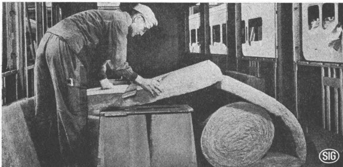
ULTRALITE Isoliermatte, langfaserig, erschütterungsfest und unbrennbar
