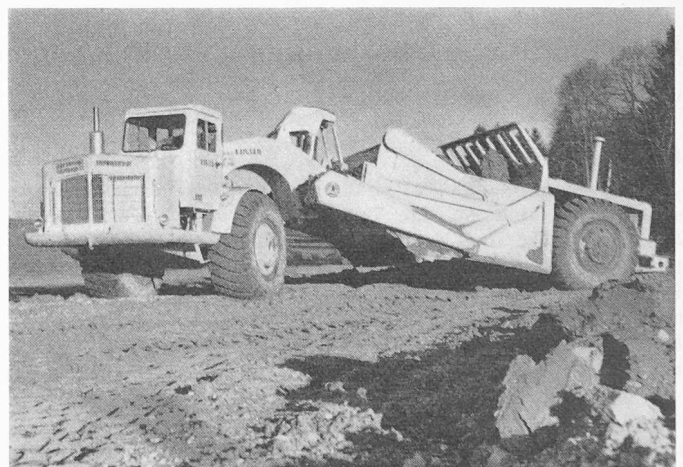
Euclid Doppelmotoren-Scraper TS-14, mit Allradantrieb, Einachs-Zugtraktor 148 PS, Scraper Fassungsvermögen 10,7 m 3 gestrichen, 12 m 3 gehäuft. Totalmasse: Länge 12,17 m, Breite 3,35 m, Gewicht 23,3 t, Tragkraft 21,3 t, Bruttogewicht 44,6 t.
