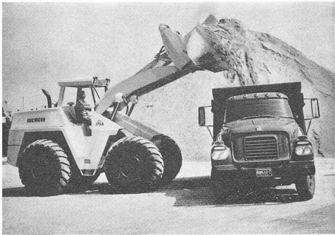
Michigan-Lader Serie II. Sechs Modelle von 0,96 bis 4,20 m 3 Schaufelinhalt, bzw. 5,9 bis 26,5 t Eigengewicht, bzw. 81 bis 310 PS Leistung.
