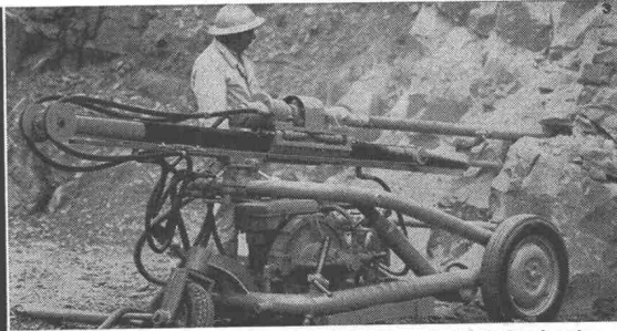
Grosslochbohrwagen mit hydraulischem Antrieb für Lochhämmer
