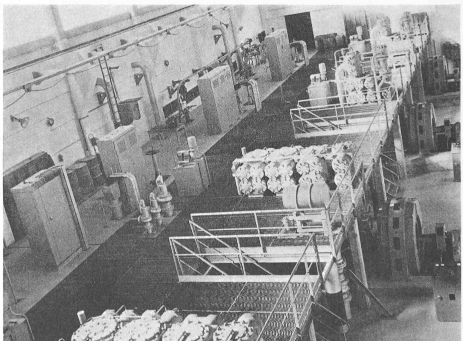
Bild 3. Burckhardt-Kompressoren für die synthetische Herstellung von Harnstoff. Im Vordergrund zwei dreistufige Kompressoren für die Verdichtung von je 7000 Nm 3 /h NH 3 -Gas von 1 auf 18 ata, Hub 300 mm, Drehzahl 375 U/min., Leistungsbedarf 1350 PS. Im Hintergrund zwei fünfstufige Kompressoren für 2900 Nm 3 /h CO 2 -Gas von 1 auf 285 ata, Hub 320 mm, Drehzahl 375 U/min., Leistungsbedarf 900 PS
