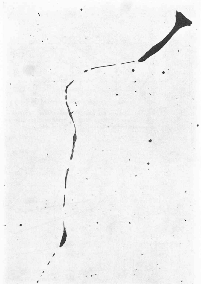
Links: Bild 7. Warmriss in einem Guss-Stück im Bereich von Typ-2-Sulfiden (Mikroskop-Vergrößerung 1:100, Reduktion der Originalaufnahme 1:0,75)
