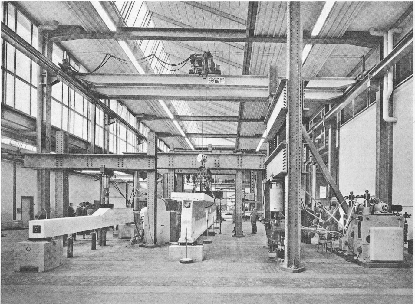
Bild 4. Der 13,60 × 24,40 m messende Aufspannboden, auf dem «Prüfmaschinen nach Mass» aufgebaut und so verschiedenste Versuche an ganzen Bauteilen durchgeführt werden können
