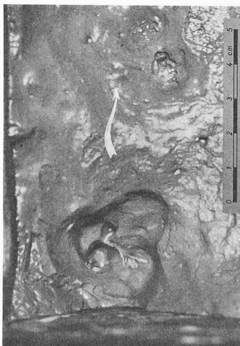
Bild 10. Kolkversuche: Detailaufnahme eines seitlichen Kolkloches von oben
