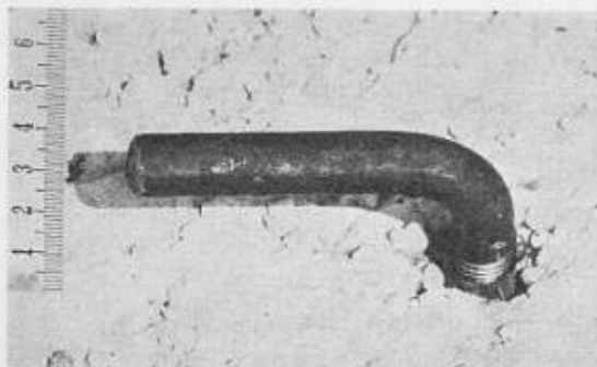
Bild 16. Winkelschraubenanker, im frischen Konstruktionsbeton versetzt. Ansicht und Querschnitt 1:4
