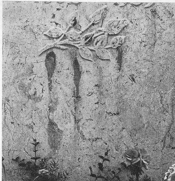
Bild 10. Fleckenbildungen ausgehend von starken Pyritanhäufungen an einem Grabstein aus Jurakalkstein
