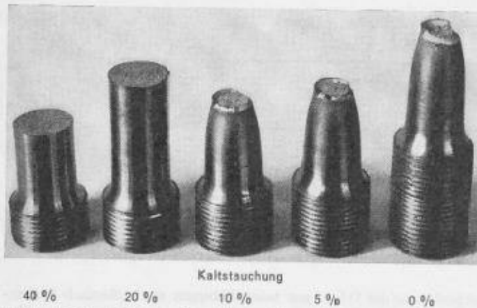
Bild 4. Bruchzustände von Zugproben nach vorgehender Kaltstauchung (Versprödung durch Kaltverformung) [1]
