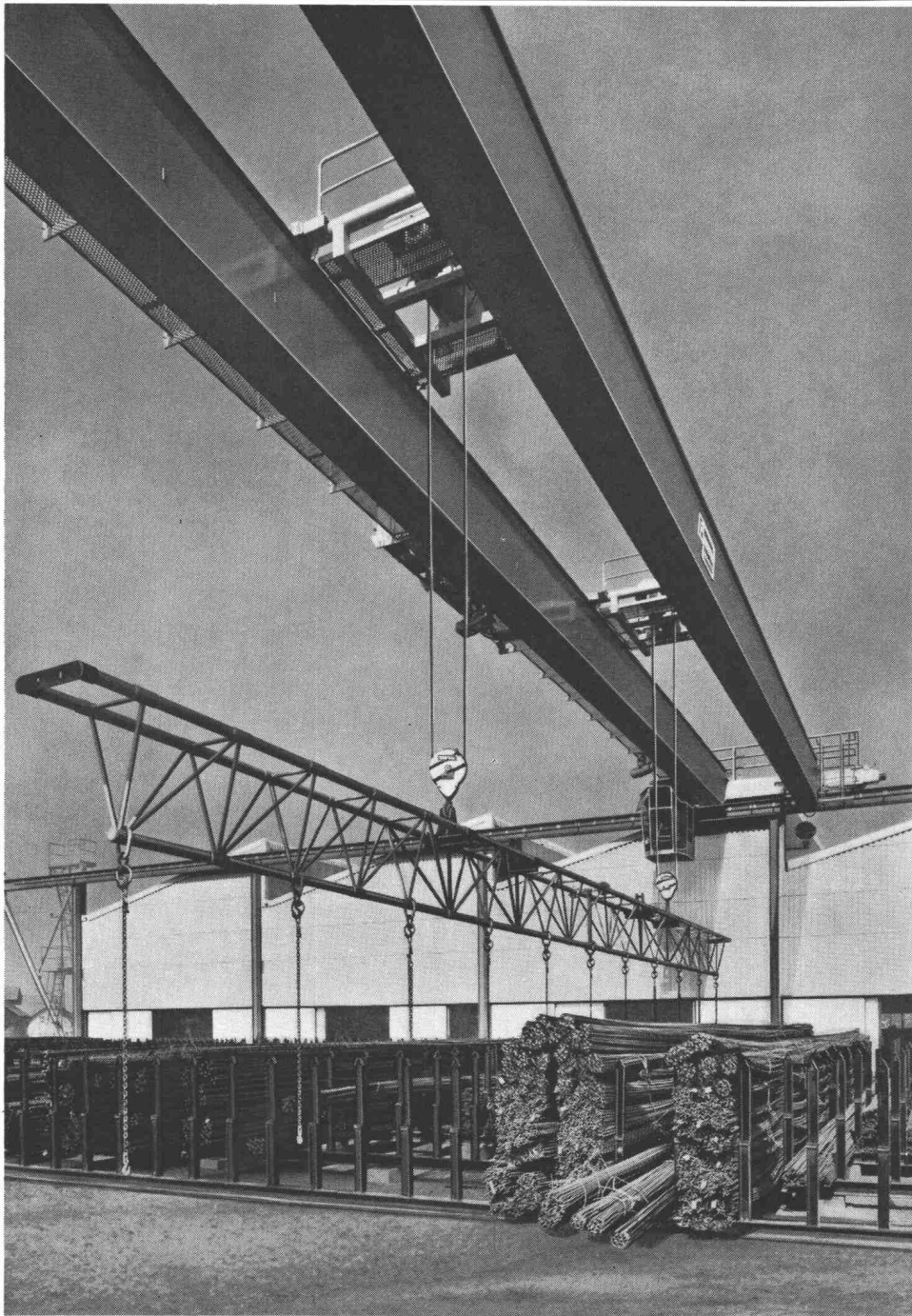
2-Träger-Laufkran, Tragkraft 10 t, Spannweite 33,5 m Zwei DEMAG-Elektrozug-Katzen mit je 5 t Tragkraft Hans Fehr AG Kranbau Dietlikon
