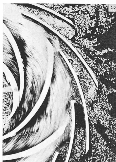
Bild A. Strömung im Leitrad bei Überlast; \alpha_1 = 9^\circ Bild B. Strömung im Leitrad bei Vollast; \alpha_1 = 9^\circ Bild C. Strömung im Leitrad bei Teillast; \alpha_1 = 9^\circ
