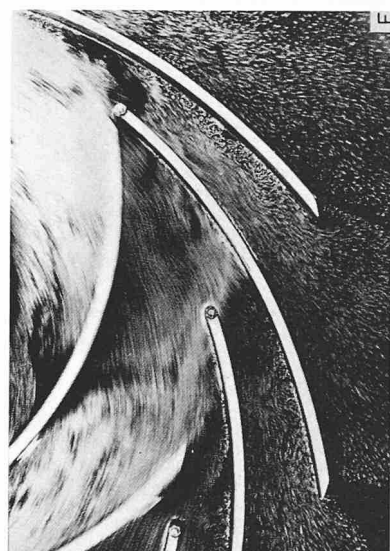
Bild D. Strömung im Leitrad bei Überlast; \alpha_1 = 14^\circ Bild E. Strömung im Leitrad bei Vollast; \alpha_1 = 14^\circ Bild F. Strömung im Leitrad bei Vollast; \alpha_1 = 14^\circ
