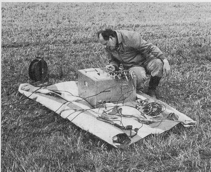
Bild 4. Vierkanal-Direktschreiber, Bauart Philips, welcher die Schwingungen von den ausgelegten elektrodynamischen Seismometern registriert
