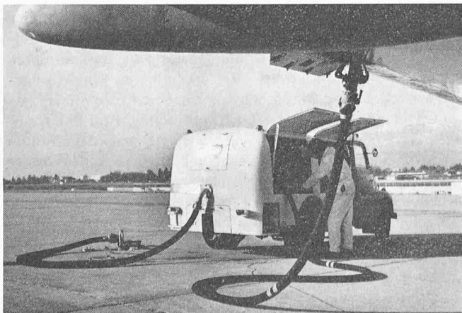
Bild 2. Über ein Austeilmotorfahrzeug wird vom unterirdischen Betankungssystem der Brennstoffbehälter eines Flugzeuges gefüllt
