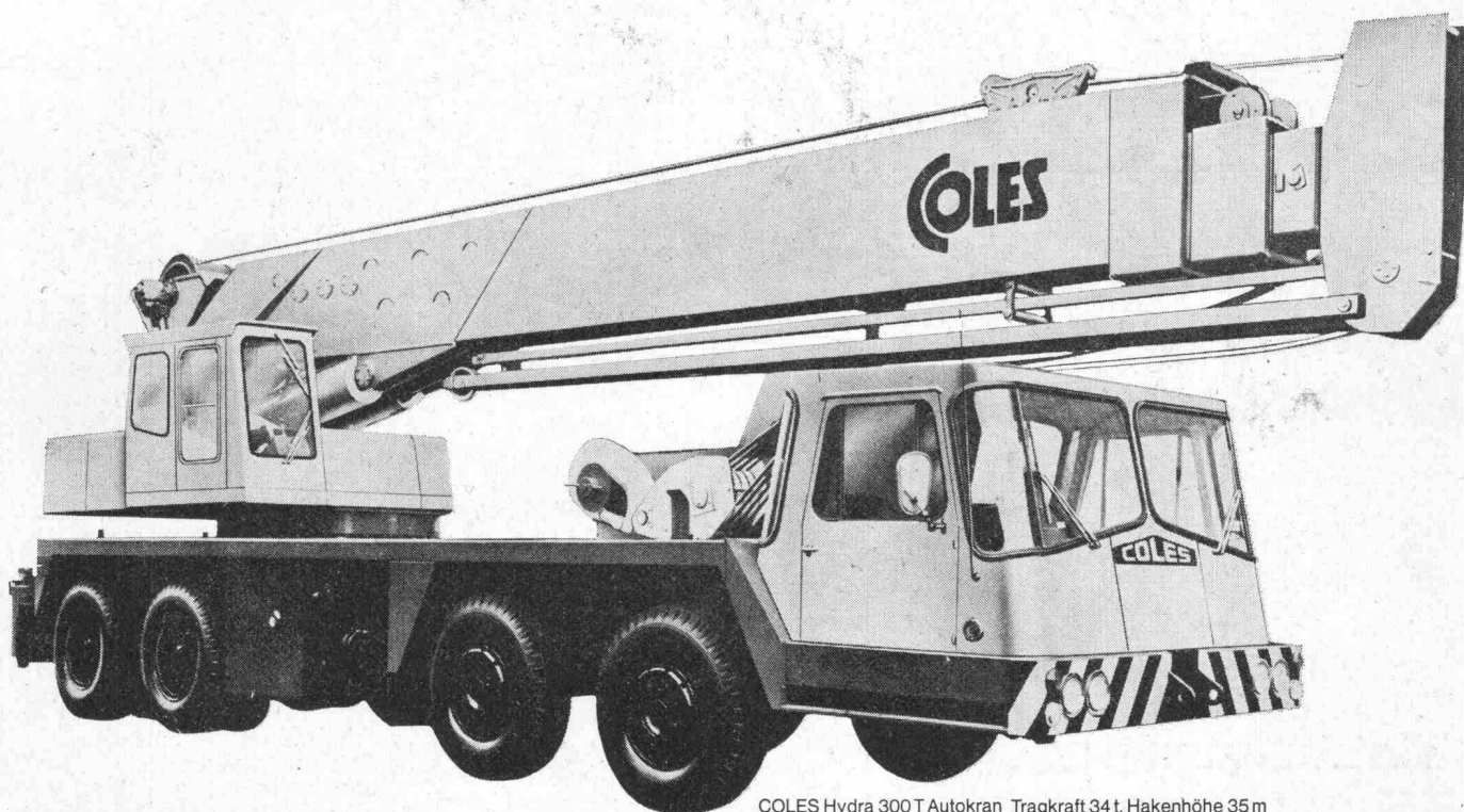
COLES Hydra 300T Autokran Tragkraft 34 t, Hakenhöhe 35 m
