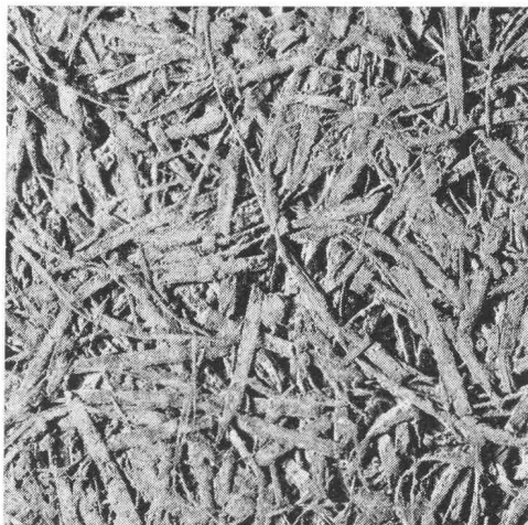
Struktur einer unbeschichteten Heraklith-Leichtbauplatte
