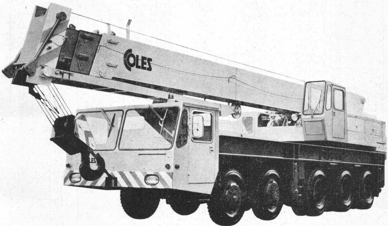
COLES L45 Autokran, Tragkraft 45 t, Hakenhöhe 53 m
