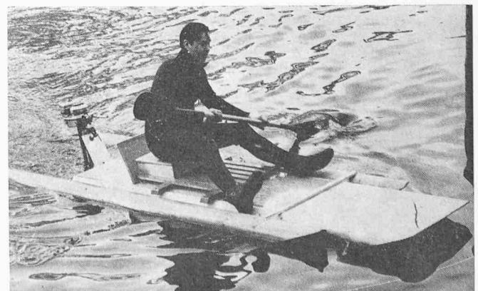
Bild 5. Motor- und Padelboot, hergestellt mit Rundholz-Schalen
