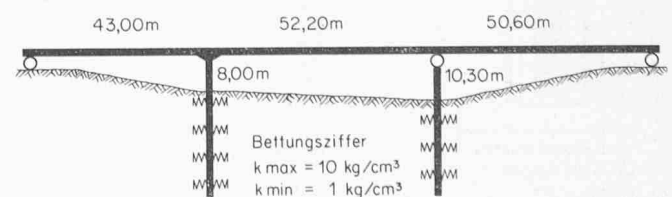
Bild 11. Statisches System der Autobahnbrücke im Grüeblichachen
