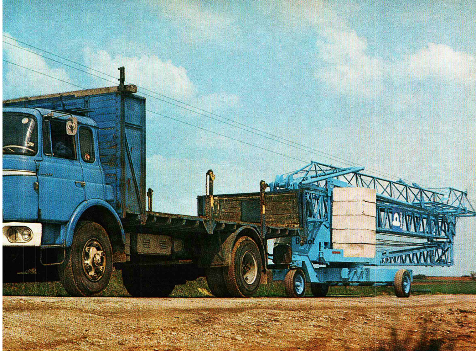
Vorne haben sich die 10 Ausgleichgewichtsblöcke nicht verschoben.
