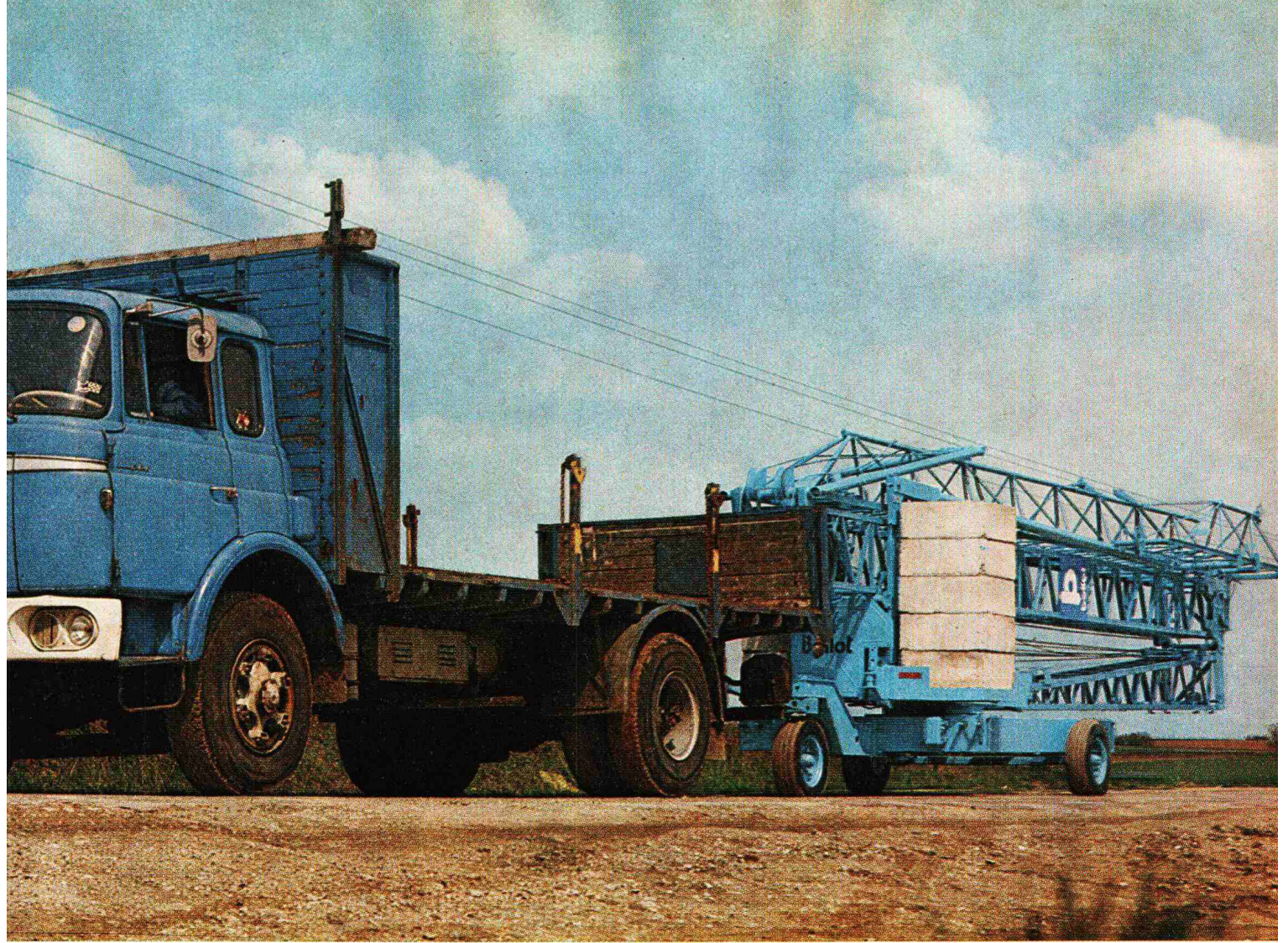
Strassentransport eines BP 1000: die 10 Ausgleichsgewichtblöcke vorne haben sich nicht verschoben.
