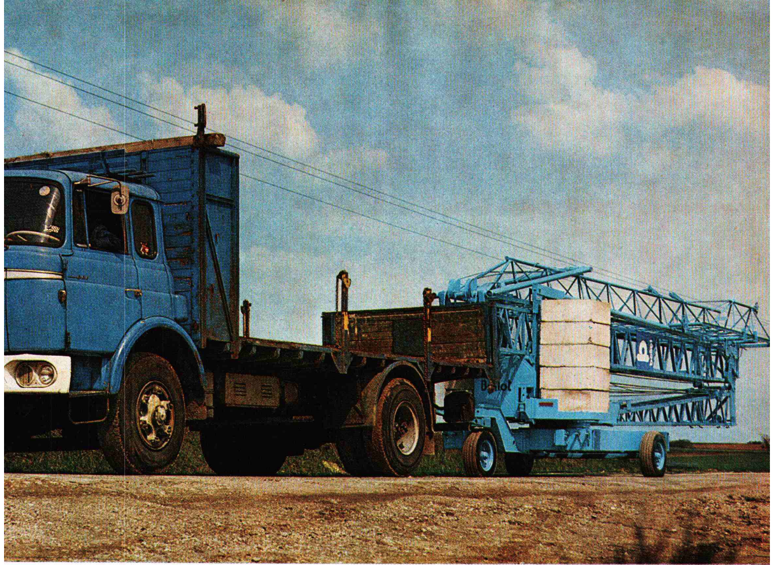
Strassentransport eines BP 1000: die 10 Ausgleichgewichtblöcke vorne haben sich nicht verschoben.
