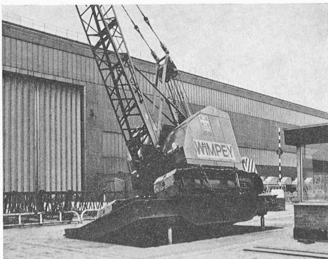
Bild 4. Prüfung der Standfestigkeit. Der Kran ist an der Plattform mit Ketten befestigt.
