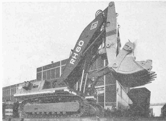
Bild 4. Der 110 t schwere Hydraulik-Bagger Typ RH 60 der Orenstein & Koppel beim Verlassen der Werkshalle
