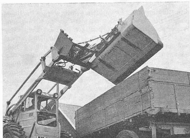
Bild 3. Einsatzversuche mit dem Prototyp einer seitlich abklippbaren Ladeschaufel
