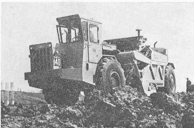
Bild 1. Schürflader Michigan 110 H-T mit Doppelmotor und Vierradantrieb
