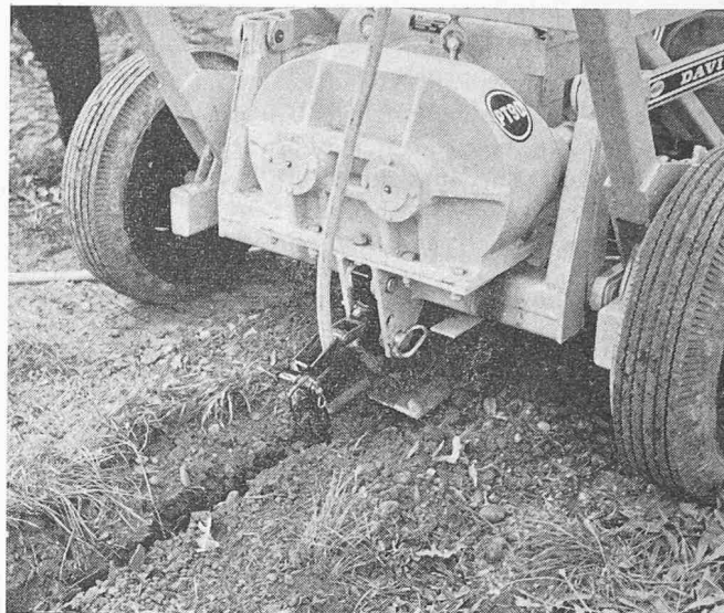
Bild 3. Mit dem Gerät Typ PT 90 erzeugter Bodenschlitz
