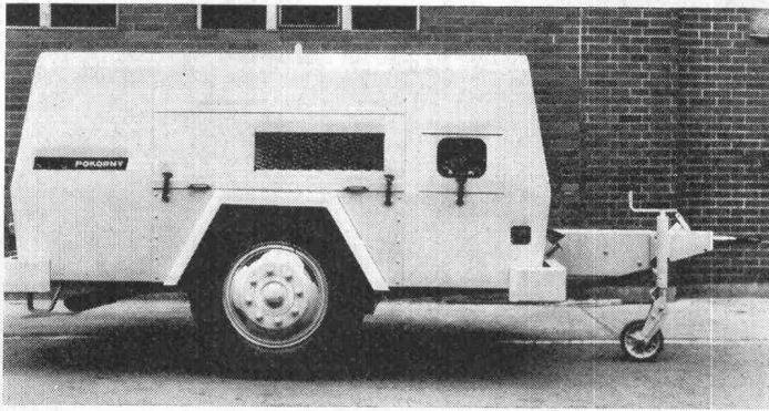
Bild 1. Fahrbarer Schraubenkompressor Typ SD 170SC, Liefermenge 17,5 m 3 /min bei 7 atü
