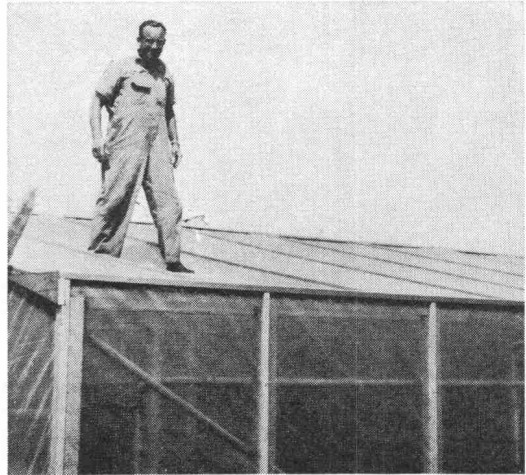
dank Gitterarmierung erstaunliche Reisskraft
