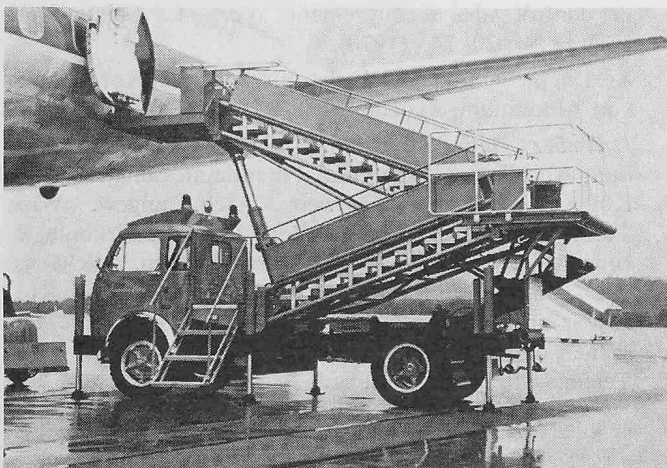
Bild 1. Die fahrbare Nottreppe bei der Vorführung in Kloten
