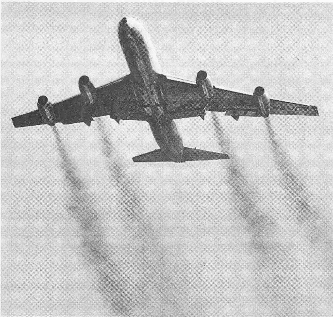
Bild 3. Beim Start treten die Feststoffpartikel im Triebwerksabgas optisch stark in Erscheinung (hier eine Convair 990 Coronado)
