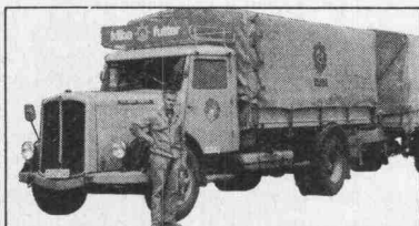
2) Saurer: 4C Überlandlastwagen Motor: Cummins 8V-185 Getriebe: Allison MT-41 (Automat)
