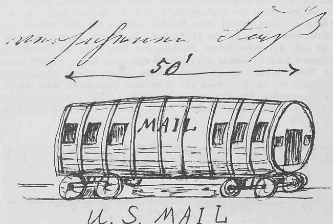
Bild 3. «Noch verdient eine eigenthümliche Wagenkonstruktion erwähnt zu werden bestehend aus einem langen mit acht Rädern versehenen Fass. Und als ich in dieses 50' lange Mail-Fass hineinschaute waren nichts als Holzspähne drin». Aus Culmanns Reisetagebuch, Union Point-Athen, 1850
