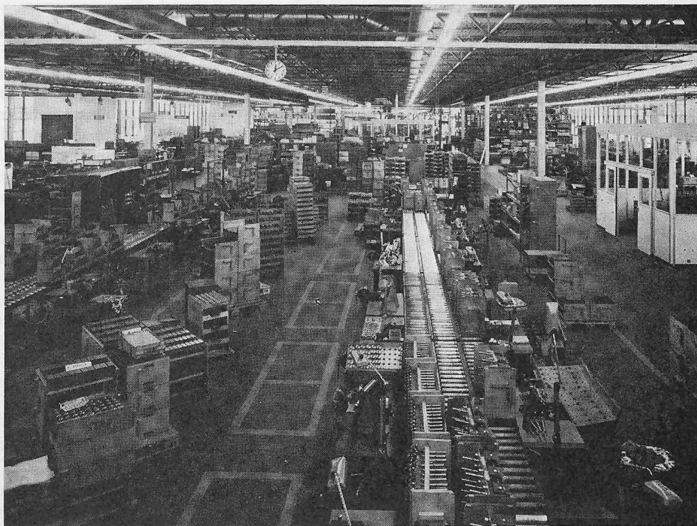
Produktionshalle (Obergeschoss, 9) mit Fließbandmontage der Texturermagnetspindel
